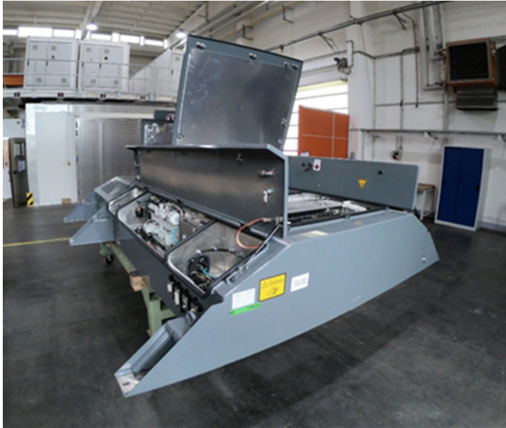
Abbildung 8: R290-Klimakompaktgerät für das Regionalverkehrsfahrzeug BR 440 der DB Regio AG in der Fertigungsstätte Schkeuditz
